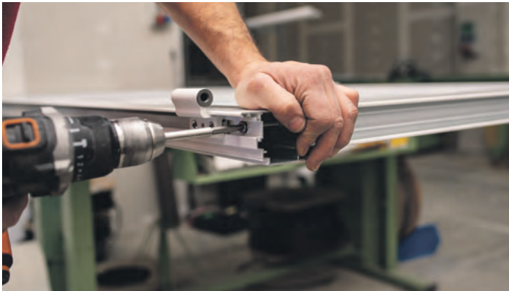
In der Werkstatt werden Profile zugeschnitten, gebohrt, verschweißt oder verschraubt. Moderne computergesteuerte Maschinen (CNC) helfen dabei, Millimeterarbeit zu leisten.
